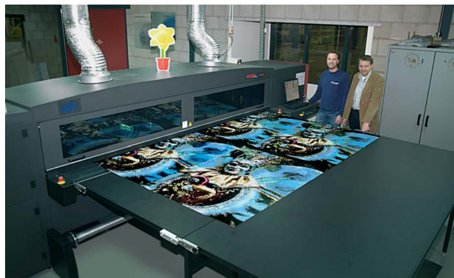
De trots van Virupa: Vutek's 320cm brede QS3200 die 5 cm materiaaldikte aankan en tevens een rol-rol productiemogelijkheid heeft. Met directeur Erwin Markerink (rechts) en operator Erwin Reukers, die de machine na de eerste week met een bloemetje beloonde.
